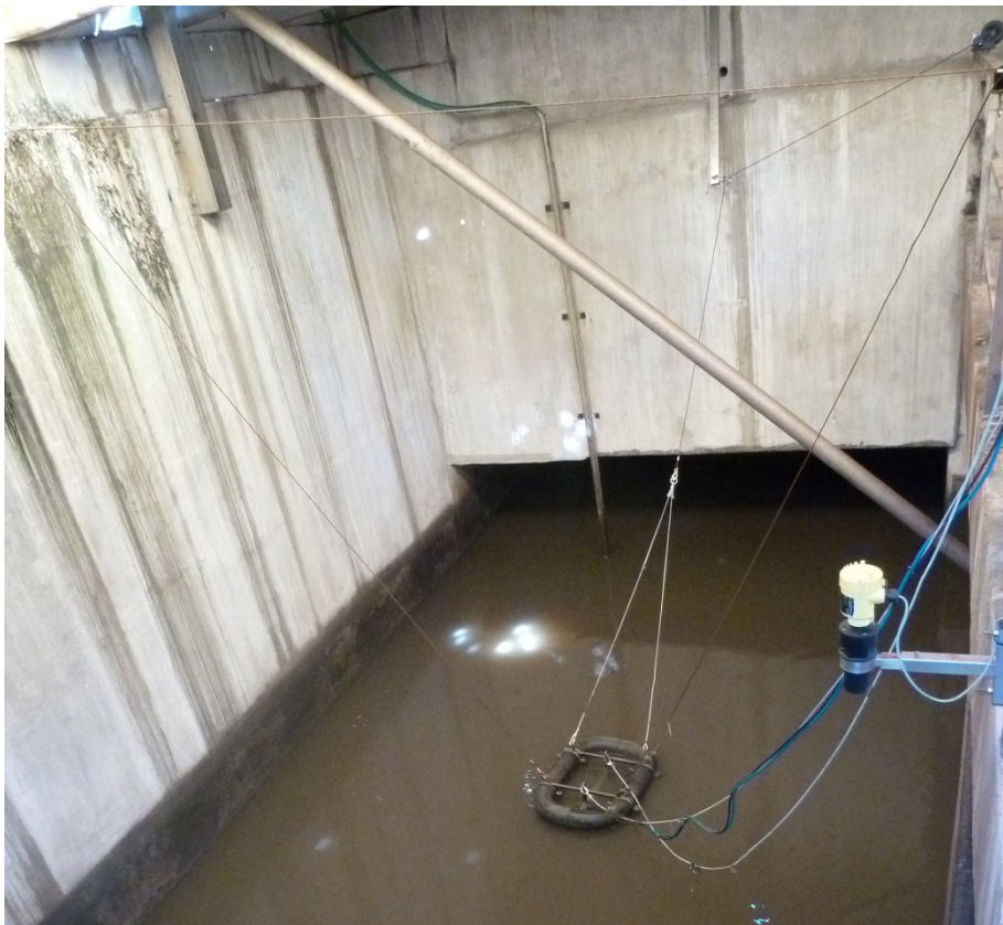
Abbildung 80: Schwimmendes Ponton und Probenahmeschlauch des Probenahmegerätes im Hintergrund an der Probenahmestelle „pcout“ im Ablauf der Vorklärbecken
