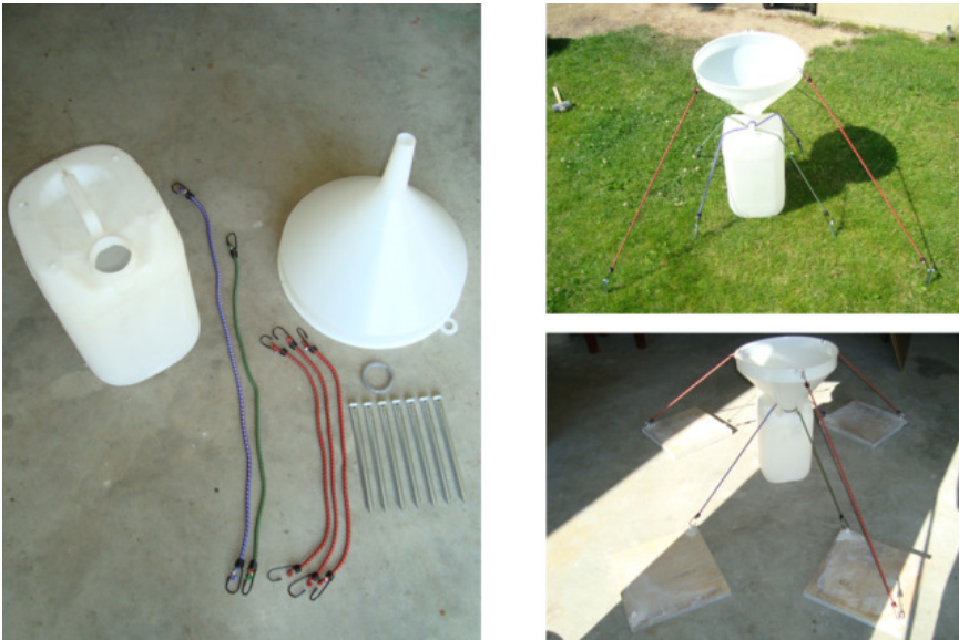
Abbildung 115: Bestandteile der verwendeten Niederschlagssammeleinrichtungen inklusive Aufstellvarianten
