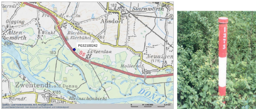
Abbildung 92: Lage und oberflügender Ausbau der GZÜV-Messstelle PG32100242
